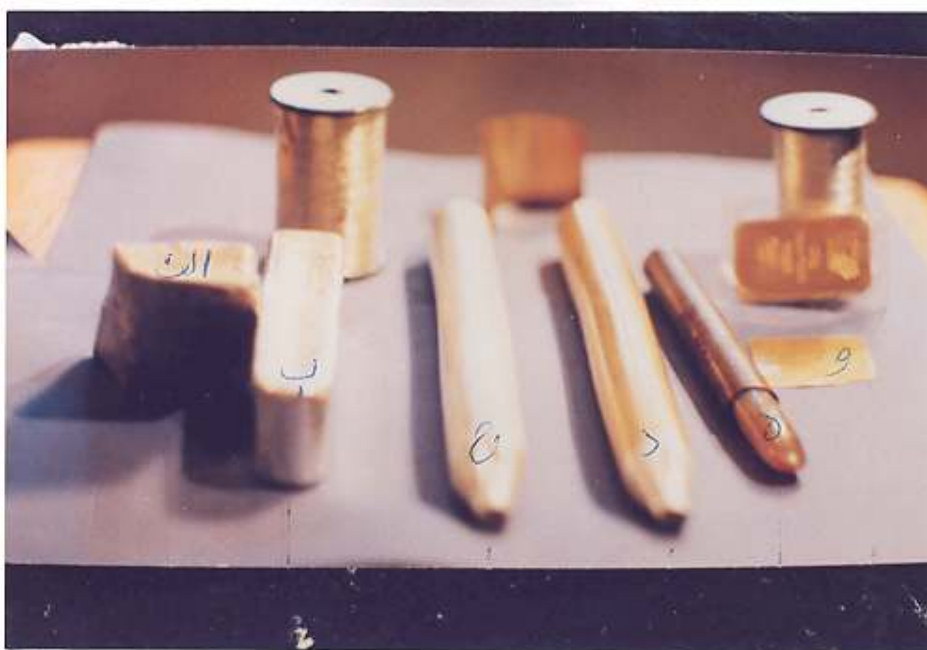
تصویر ۳- مراحل مختلف تبدیل نقره خام به مفتول نقره‌ای با روکش طلا
