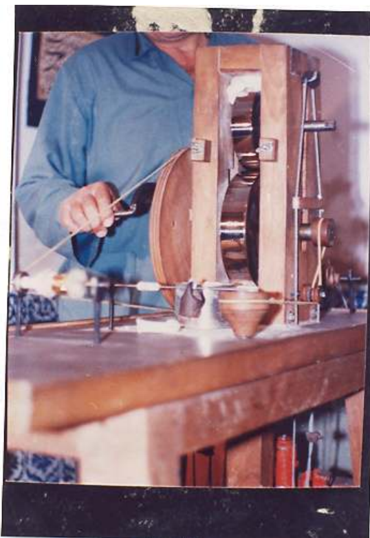
تصویر ۸- دستگاه نخ‌کوبی به جهت تخت کردن سیم زرین
