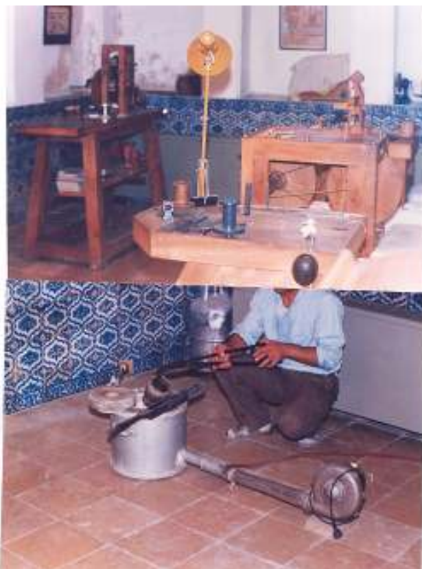
تصویر ۱- عمل ذوب نقره خام و ریختن آن به داخل ریجه برای تشکیل شمش‌های نقره‌ای
