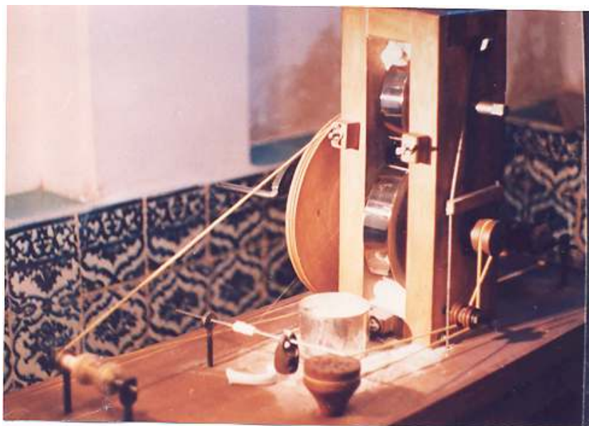
تصویر ۹- دستگاه نخ‌کوبی و چگونگی انتقال سیم زرین بر روی قرقره
