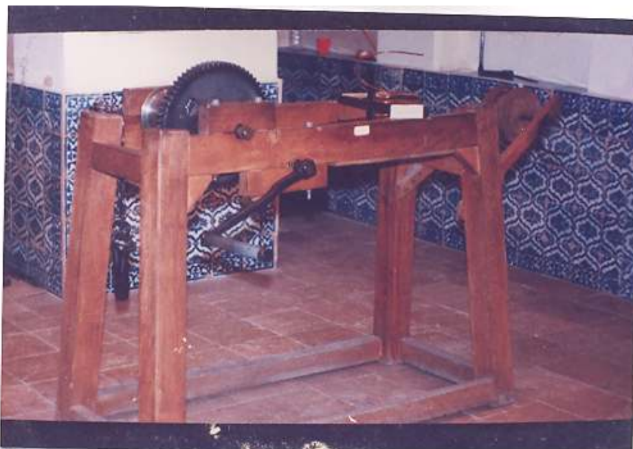
تصویر ۵- دستگاه ضخیم‌کشی به جهت عبور مفتول نقره‌ای از داخل سوراخهای حدیده
